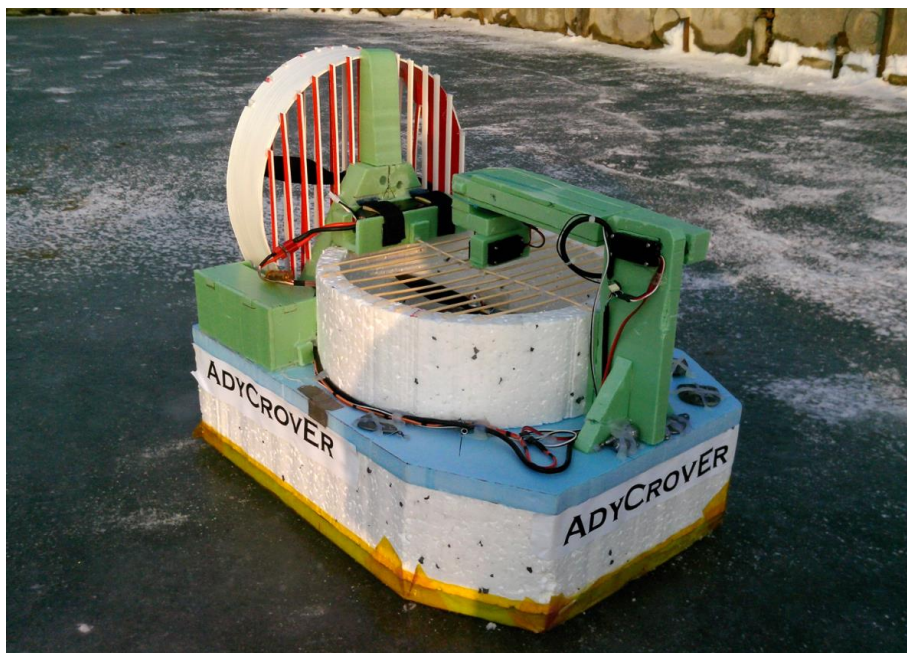
2. ábra: Elkészült légpárnás jármű
