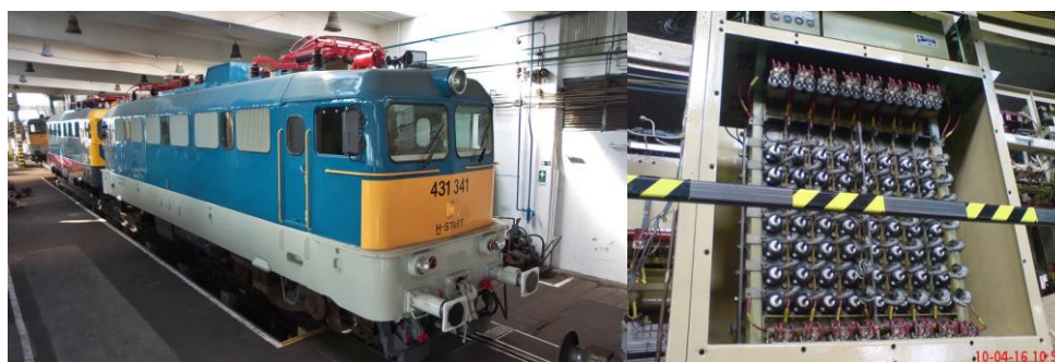
3. ábra: V43-as mozdony és a diódás egyenirányító szekrény
